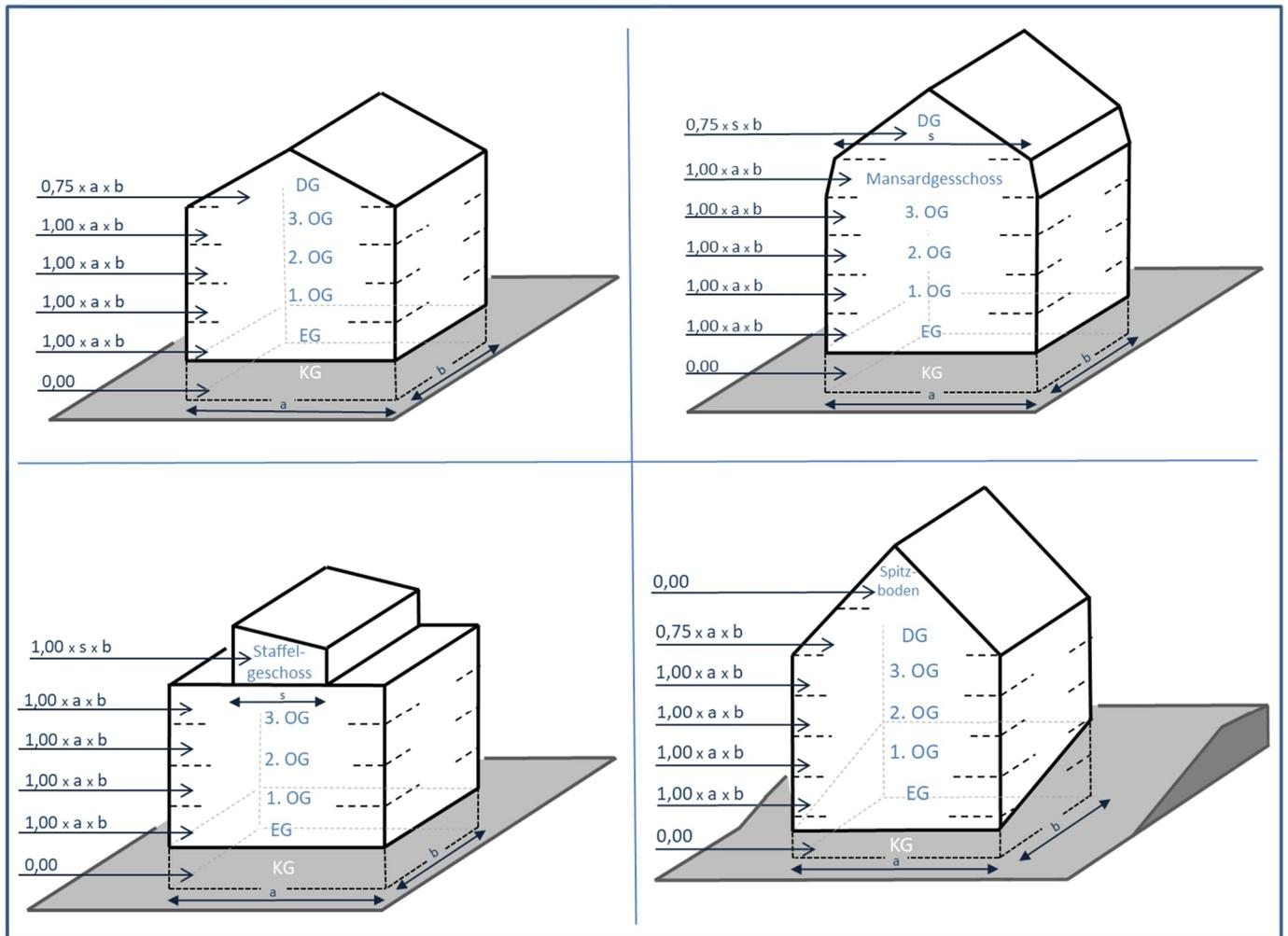
16.(4).3 Sind im Dachraum mehrere Dachgeschosebenen ausgebaut oder ausbaufähig, ist § 16 Absatz 4 Satz 3 für alle Dachgeschosebenen anzuwenden. Staffelgeschose werden dagegen nach § 16 Absatz 4 Satz 4 in vollem Umfang angerechnet; aufgrund der insoweit vergleichbaren Situation gilt dies in der Regel analog auch für Mansardgeschose. In Hanglagen kann in der Regel davon ausgegangen werden, dass die untersten Geschosse nach § 16 Absatz 4 Satz 2 als oberirdische Geschosse gelten.
