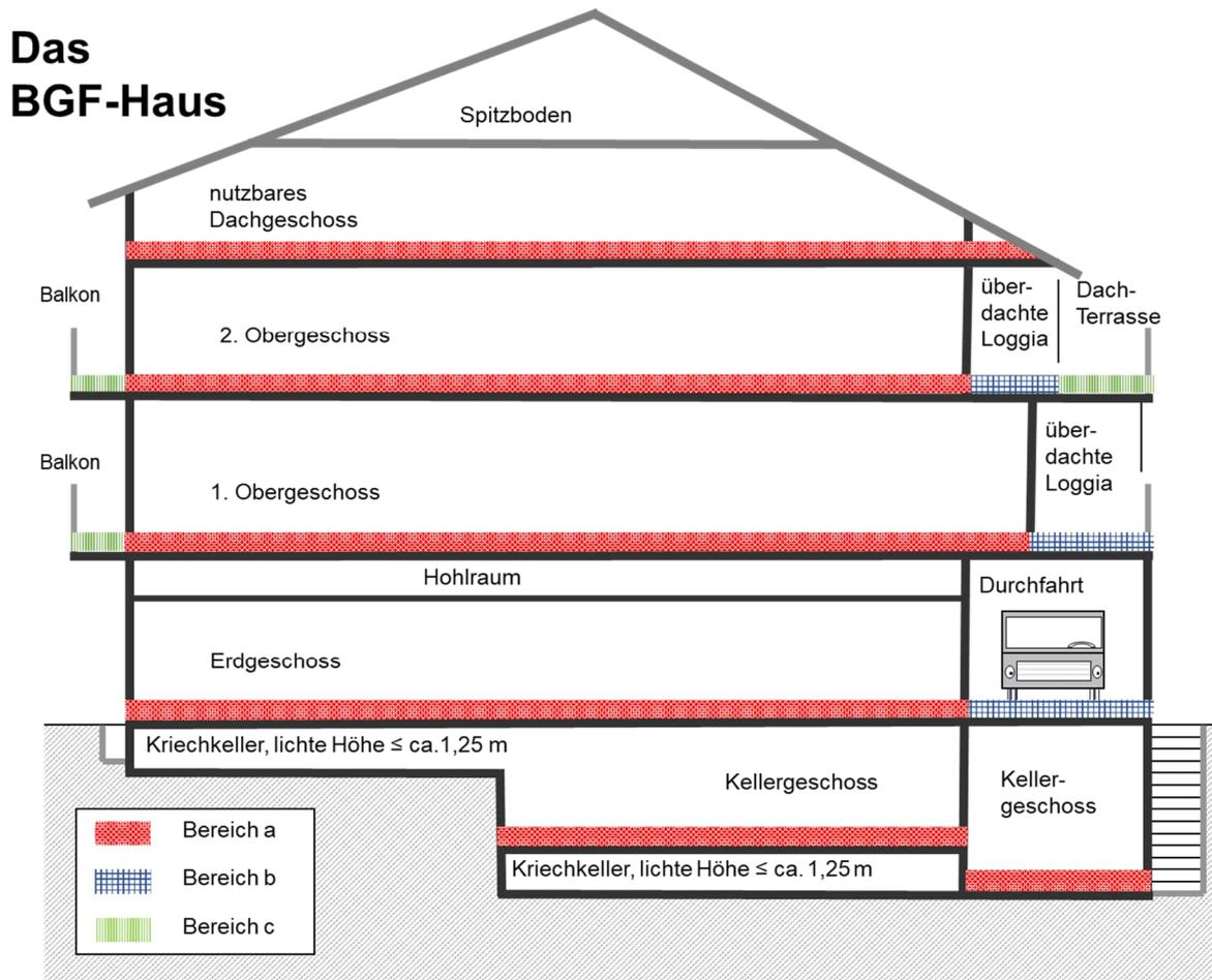
IV.(I).4 Die Anrechenbarkeit der Grundflächen im Dachgeschoss nach Anlage 4 Nummer I.2 Absatz 5 verdeutlicht folgende Abbildung:
